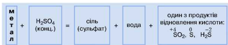
Рис. 27. Схема взаємодії концентрованої сульфатної кислоти з металами
