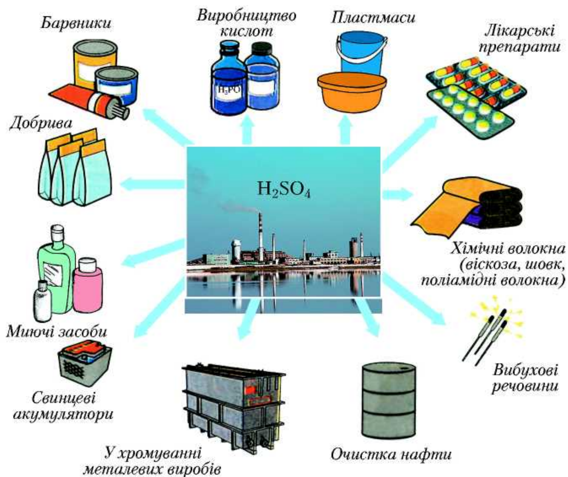
Рис. 29. Схема застосування сульфатної кислоти
